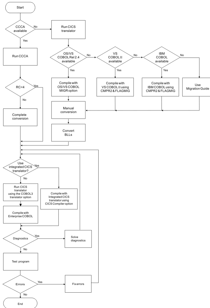
図 2. CICS コマンドを含む OS/VS COBOL プログラムを変換する手順
